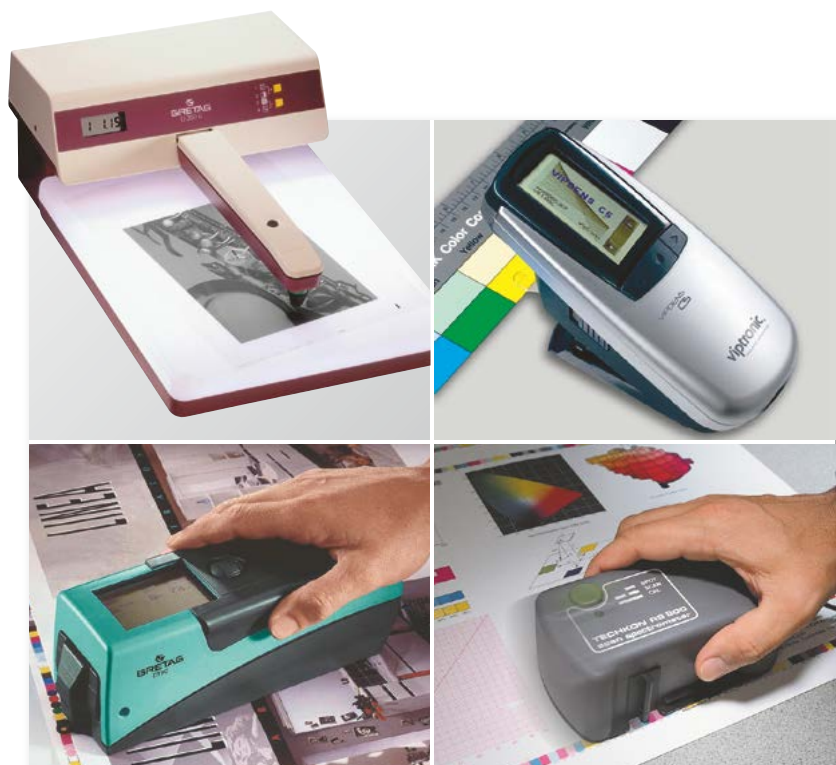
1.5.1-1: Bauformen von Densitometern: Durchlichtdensitometer (oben links), Handdensitometer (oben rechts, unten links), Scandensitometer zur Abtastung von Kontrollstreifenstücken (unten rechts)
