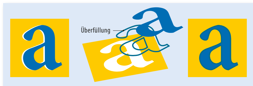
2.2-1: Beim Überfüllen überlappt das Objekt den Hintergrund. Bei der Unterfüllung überlappt der Hintergrund das Objekt.
